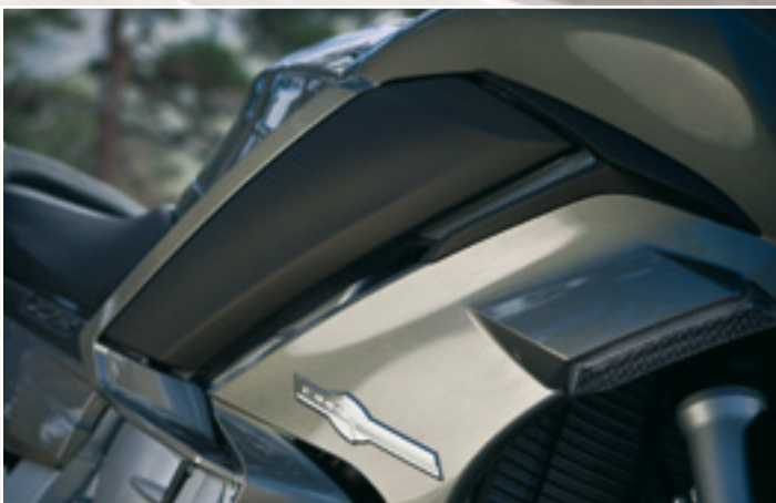
Flexibel: Ohne Werkzeug ausstellbare Flaps optimieren den Wetterschutz.
