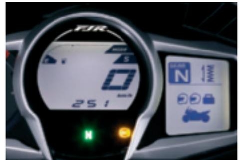
**Übersichtliches, informatives Cockpit mit Anzeige der Fahrwerkeinstellung (r.).**
